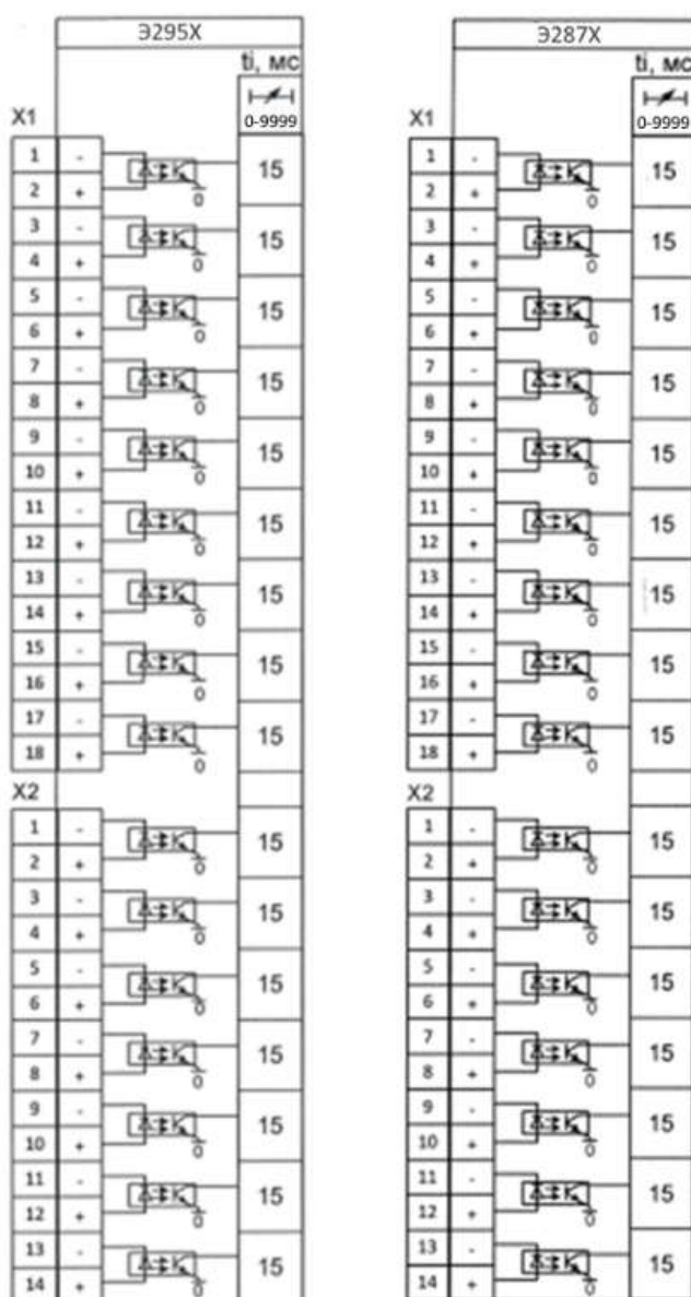
Рисунок Б.2.2 – Схемы подключения блоков типа Э295Х и Э287Х
